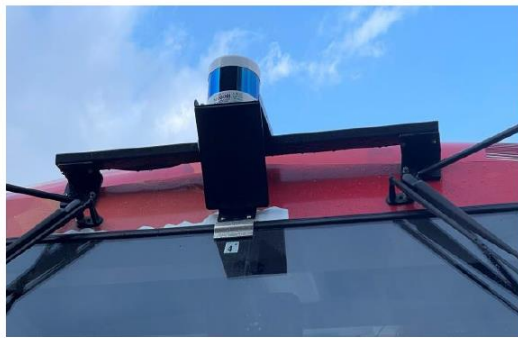
周囲状況を把握するセンサー（LiDAR）を設置
